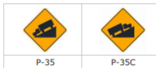
Figura 24. Señales preventivas – pendiente longitudinal.
