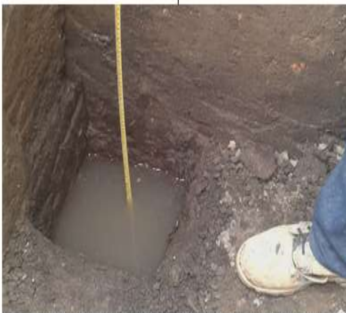
FIGURA N° 03: Llenado del agujero con agua hasta una altura de 30 cm. por encima de la capa de grava, lectura de los intervalos de descenso.
