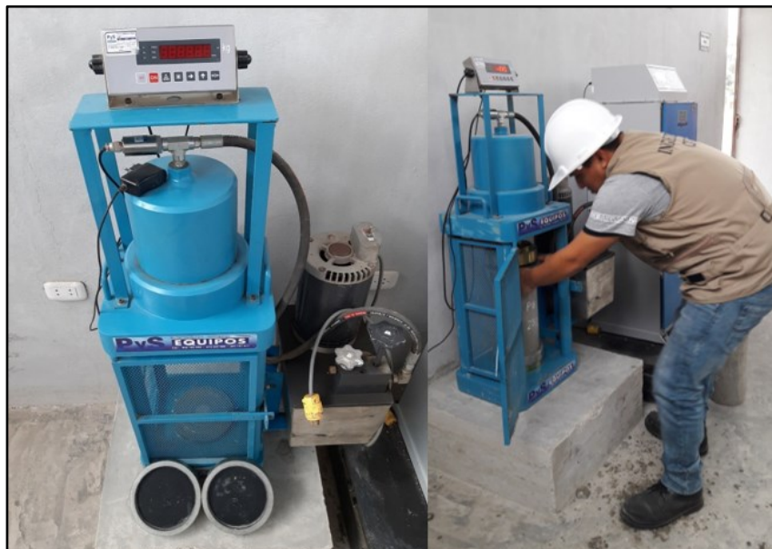
Figura 27: Ensayo de resistencia a la compresión.
