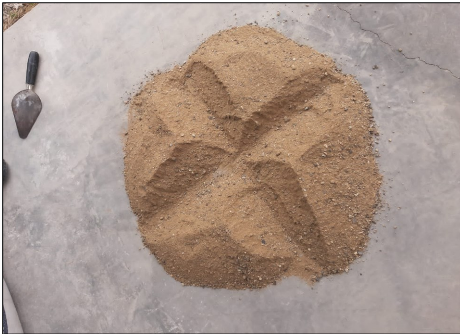
Fotografía N° 06: Cuarteo de Agregado Fino para Ensayo Granulométrico.
