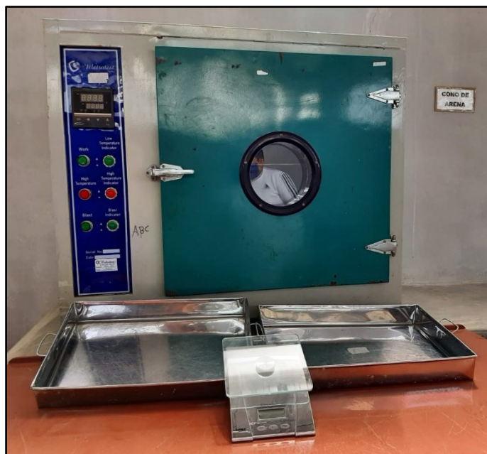
Figura 13: Equipos para el contenido de humedad
