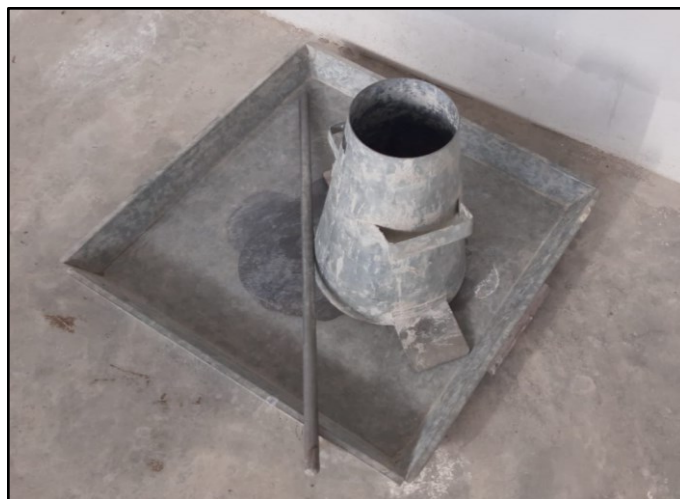
Figura 21: Equipos para el asentamiento de concreto.
