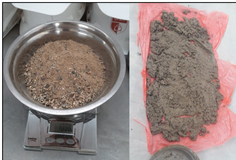
Figura 18: Agregado fino en el ensayo de la densidad relativa.
