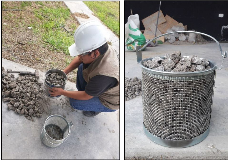
Fotografía N° 03: Tamizado de Concreto de Demolición.
