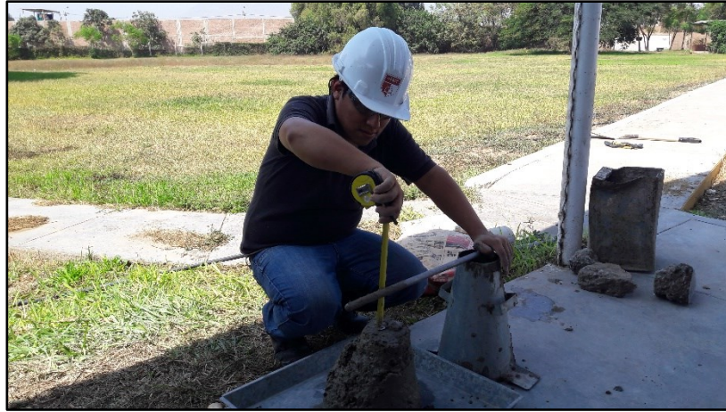
Figura 22: Medición del asentamiento.
