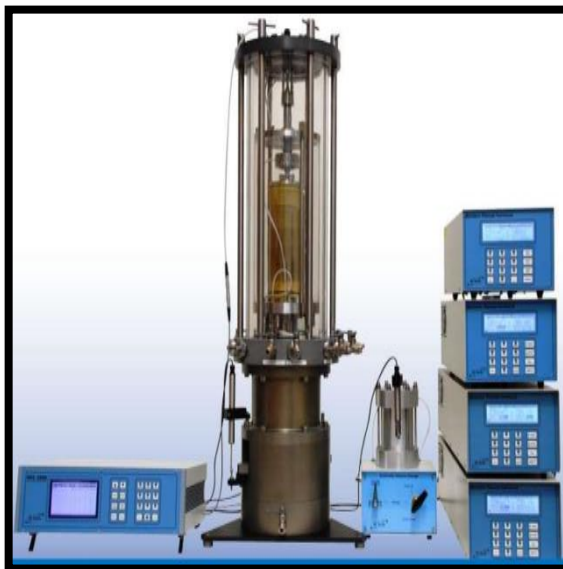
Figura 14. Ensayo triaxial Cíclico. Fuente: geotecnología
